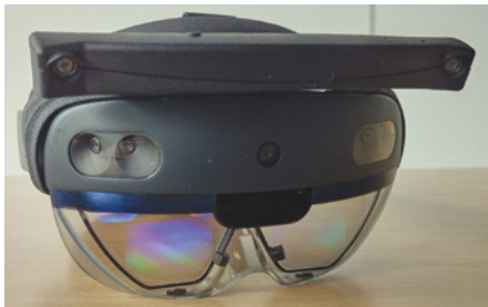
Gogle MXR Tactics z systemem śledzenia i odbiornikiem gotowe do użycia
